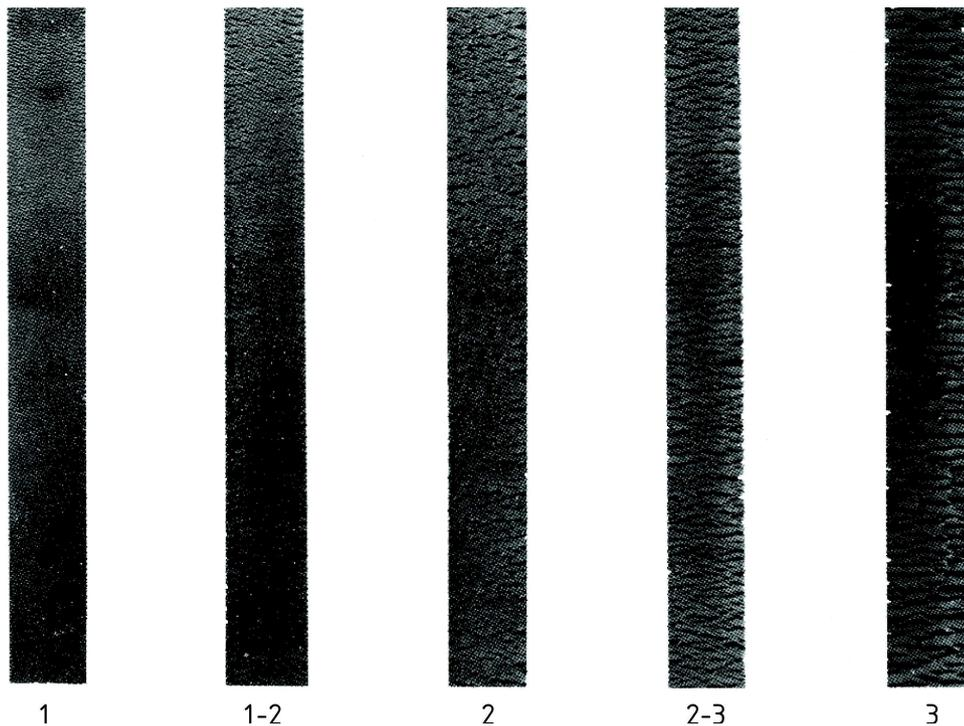
**Bild 4 — Bewertungsstufen zur Rissbeurteilung nach Verfahren A**
